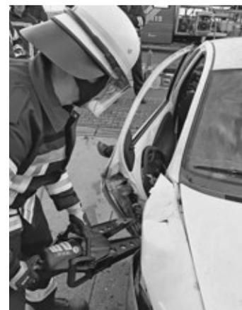
**Eine Tür eines PKWs wird mit einem hydraulischen Spreizer geöffnet.**
