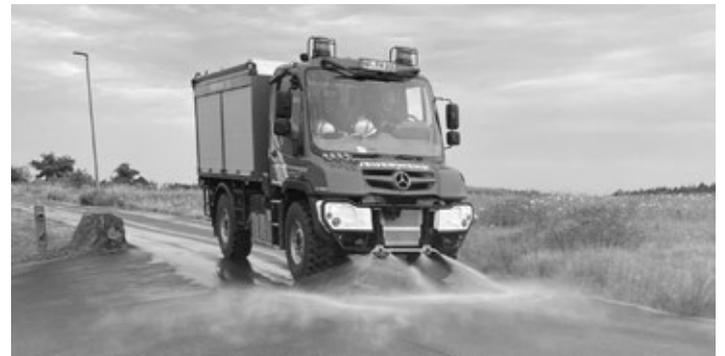
**Das Waldbrandtanklöschfahrzeug in Aktion. Mit Düsen wird während der Fahrt Wasser versprüht. So können Vegetationsbrände bekämpft werden.**
