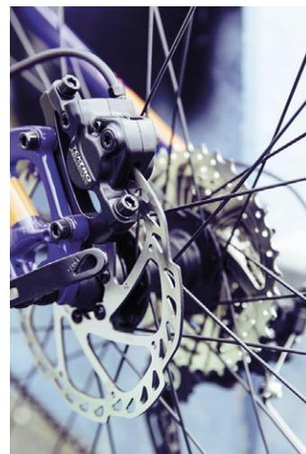
sogenannten semi-metallischen Belagmischungen benötigen diesen Schritt in der Regel nicht zum Ausgasen, da sie keine oder nur sehr geringe Anteile flüchtiger Lösemittel enthalten. Allerdings müssen auch sie hohen Temperaturen ausgesetzt werden, damit sich die nötige Reibschicht ausbilden kann. Das korrekte Einbremsen verhindert also nicht nur das Verglasen und Quietschen der Bremsen, sondern erspart auch die Kosten für neue Beläge und Scheiben.
