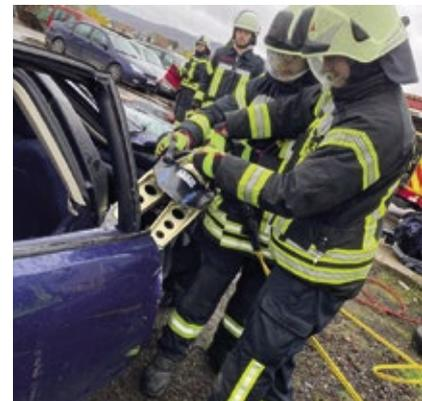
**Mit schwerem Gerät, in diesem Fall der Spreizer, wird die Autotür mit Leichtigkeit aufgebrochen.**
